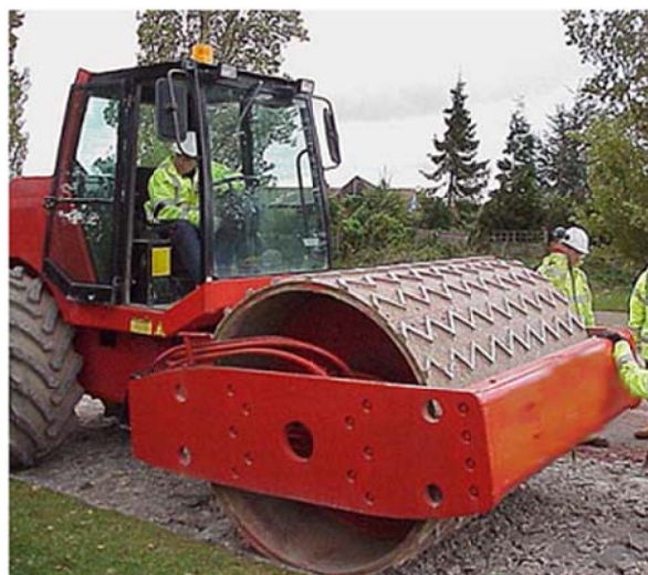
Rysunek 2. Walec z bębniem o powierzchni w kształcie litery Z (zygzak)
