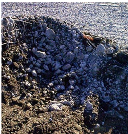
Rysunek 4. Odkrywka po pobranej próbie kruszywa, do badań uziarnienia.
