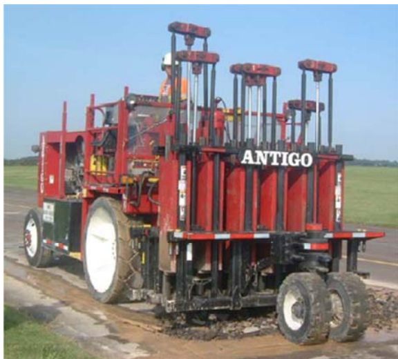
Rysunek 1. Multi-Head Breaker (łamacz wielogłowicowy).
